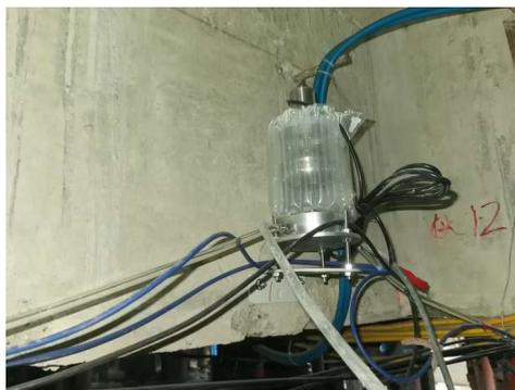
图 2.24 托盘梁沉降测点现场图
