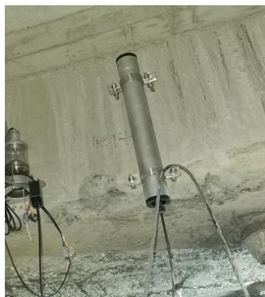
图 2.20 托盘梁倾斜测点现场图
