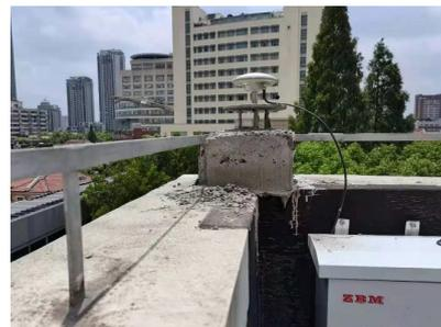
图 2.16 水平位移测点现场图
