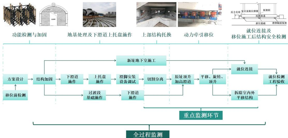
图 2.1 建筑移位工程流程
