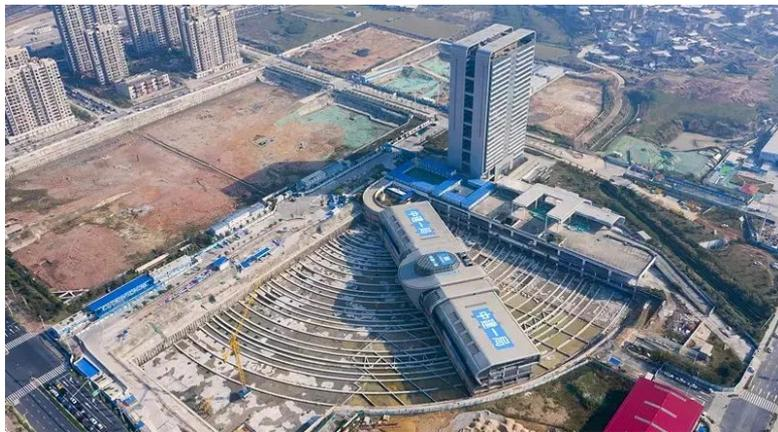
图 1.17 厦门后溪长途汽车站移位工程
