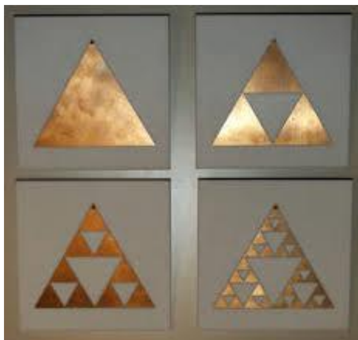
图 1.25 分形天线的分形结构逐次迭代过程（谢尔宾斯基三角分形）
