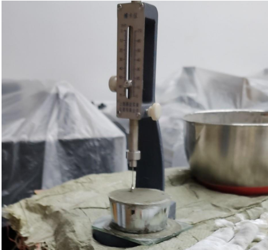
图 4.11 利用维卡仪测定水泥凝结时间
