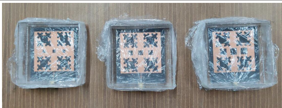
图 5.22 放置在亚克力盒子中且带有防水封装的带有中部孔洞的 2 阶分形贴片天线传感器
