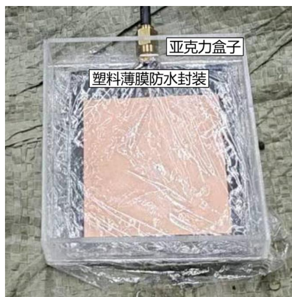
图 4.9 放置在亚克力盒子中且带有防水封装的矩形贴片天线传感器
