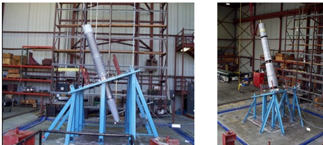
图 1.7 高压变压器套管振动台试验
