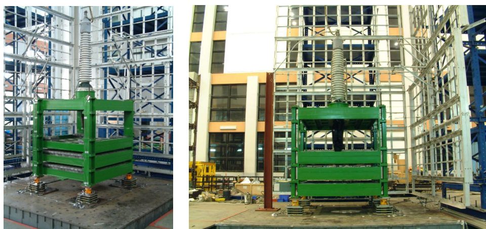
图 1.8 变压器-套管体系模型隔震振动台试验示意图
