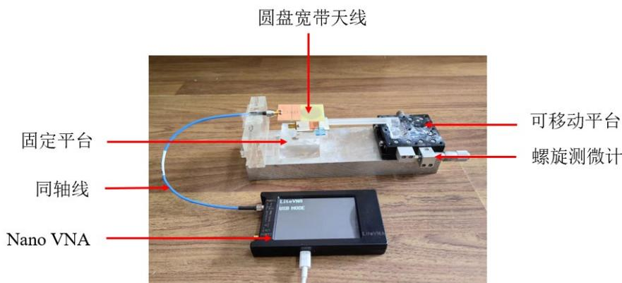
图 5.24 圆盘宽带天线正对贴片天线长度方向无线问询试验
