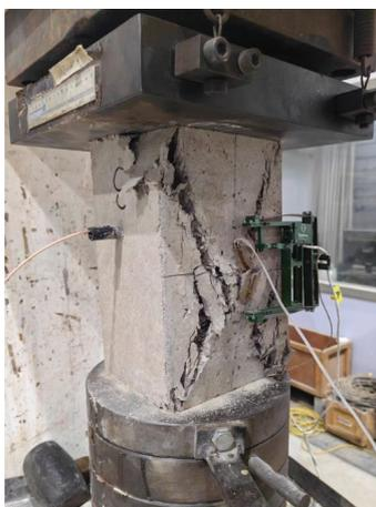
图 6.21 压缩破坏后的混凝土试件
