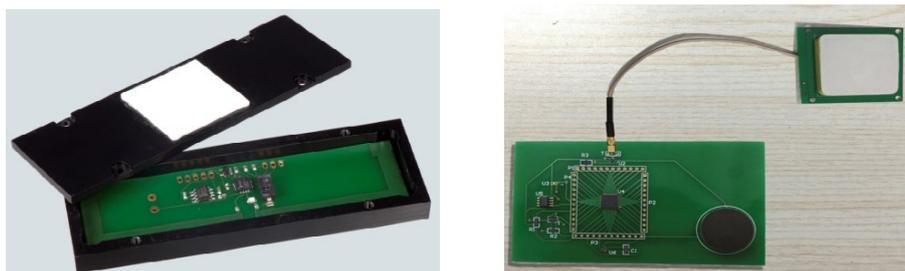
图 1.1 混凝土埋置式的温度传感器与湿度传感器<sup>[34]</sup>
