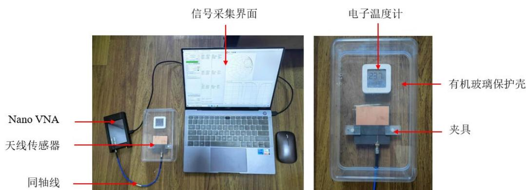
图 3.34 贴片天线传感器环境温度监测试验
