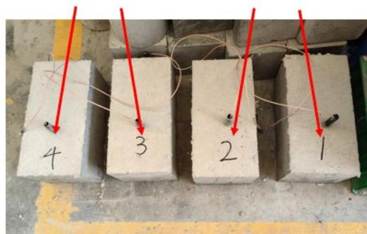
图 6.7 养护结束后的混凝土试件
