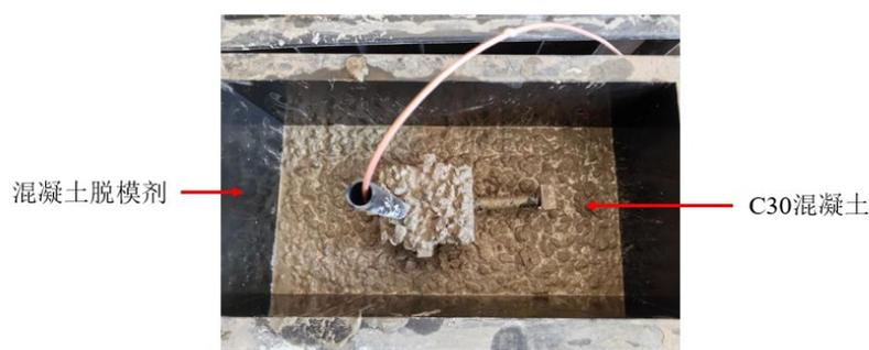
图 6.5 混凝土试件浇筑过程
