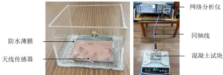
图 1.17 贴片天线传感器用于混凝土含水率测试示意图<sup>[154]</sup>
