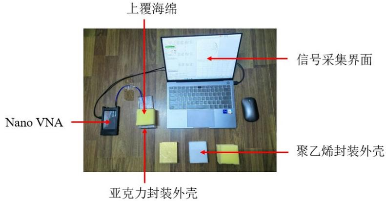
图 4.20 非屏蔽材料封装天线传感器试验测试
