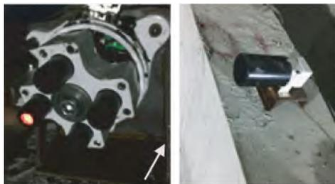
(a) 激光发射器 (b) 激光接收器
