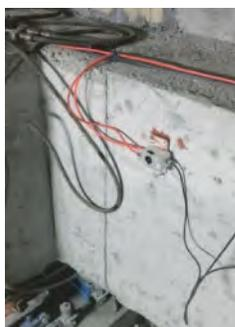
图 5 静力水准仪现场安装图
