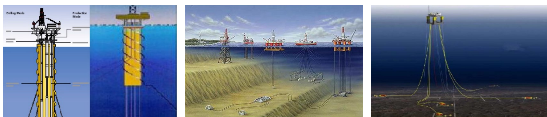
(a) 立管结构 (b) 独立柱式平台 (c) 锚缆
