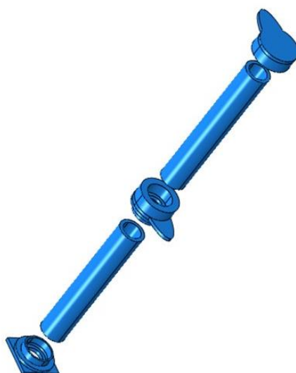
图 2.9 支柱绝缘子有限元模型详图
