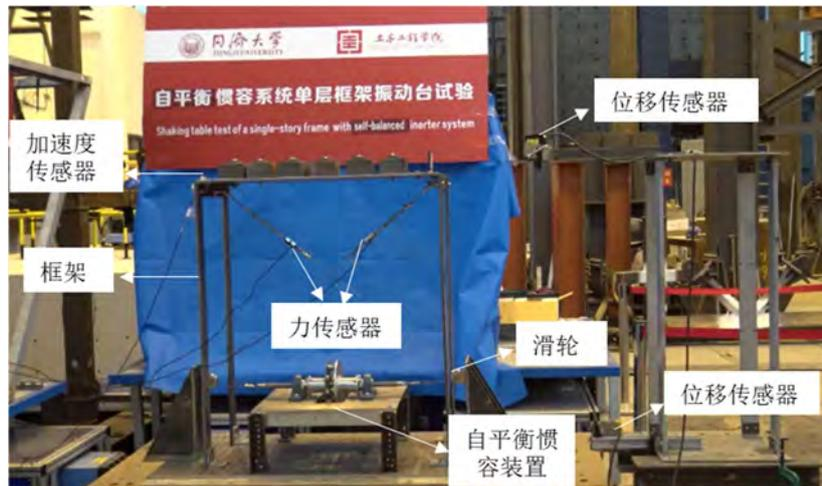
图 3.31 振动台试验装置示意图
