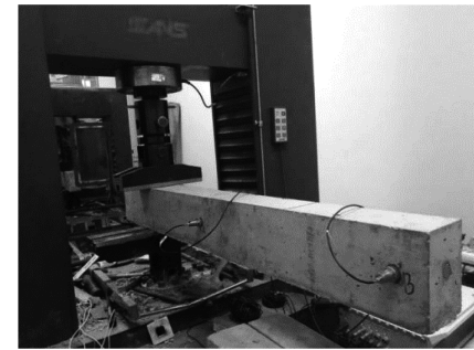
图4 悬臂梁法测试阻尼(尺寸单位:mm)
