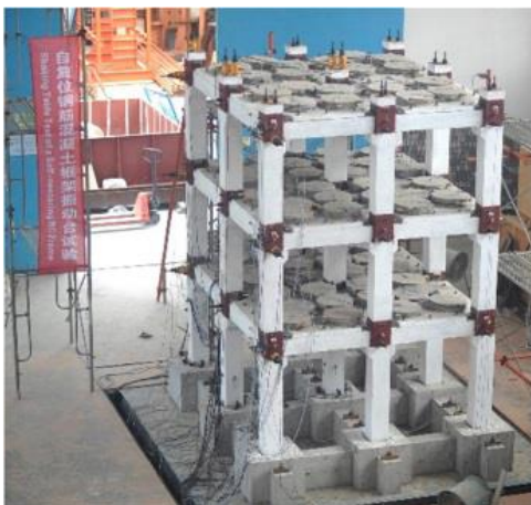
图 1.3 自复位钢筋混凝土框架结构 [40,41]
