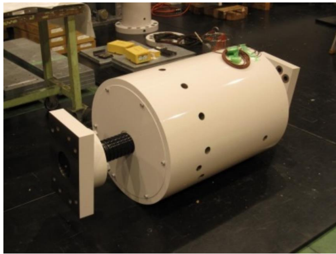
图 1.3 一种滚珠丝杠惯容器实物图
