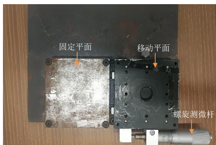
图 3.11 裂缝发生器示意图
