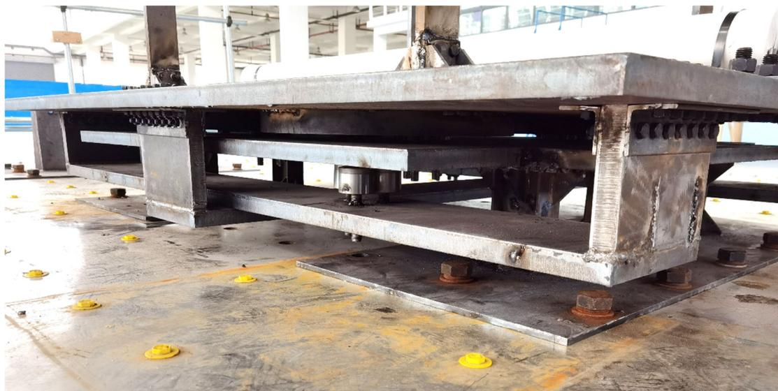
图 4.7 隔震层整体实物图
