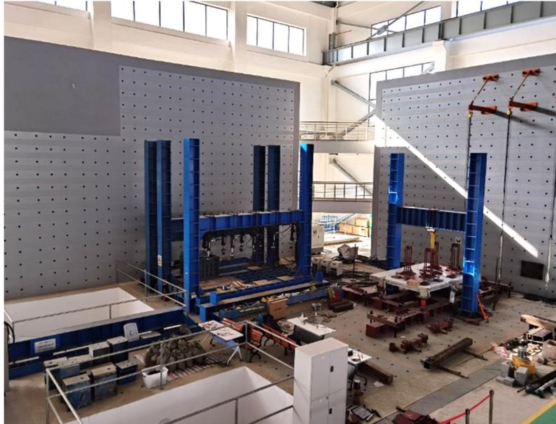
图 2.11 L 型反力墙及反力钢架
