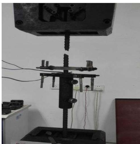
图 2.6 钢筋拉断破坏
