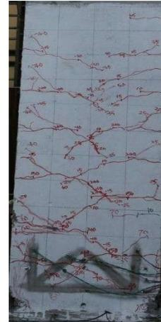
(3) C-BM 试验破坏形态
