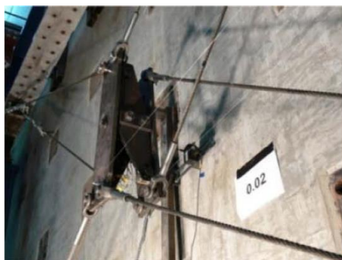
图 1.7 超弹性金属记忆环拉索系统 [76] 实物图
