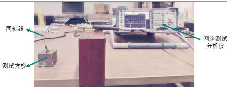
图7 谐振频率测试图
