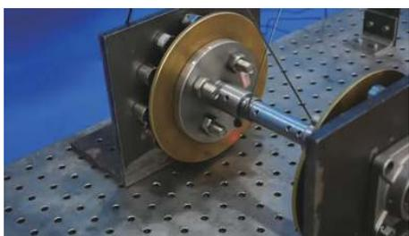
图 4 电涡流阻尼器装置
