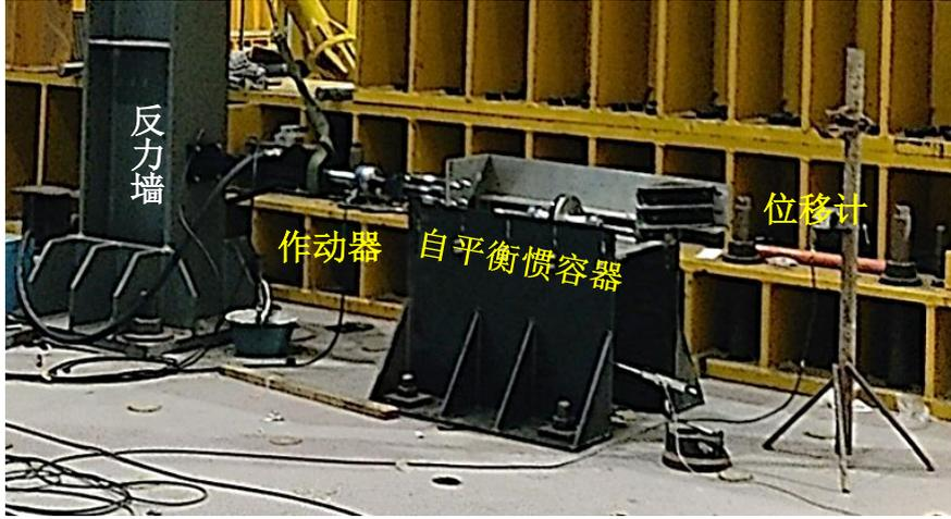
图 4.4 实验装置实物图
