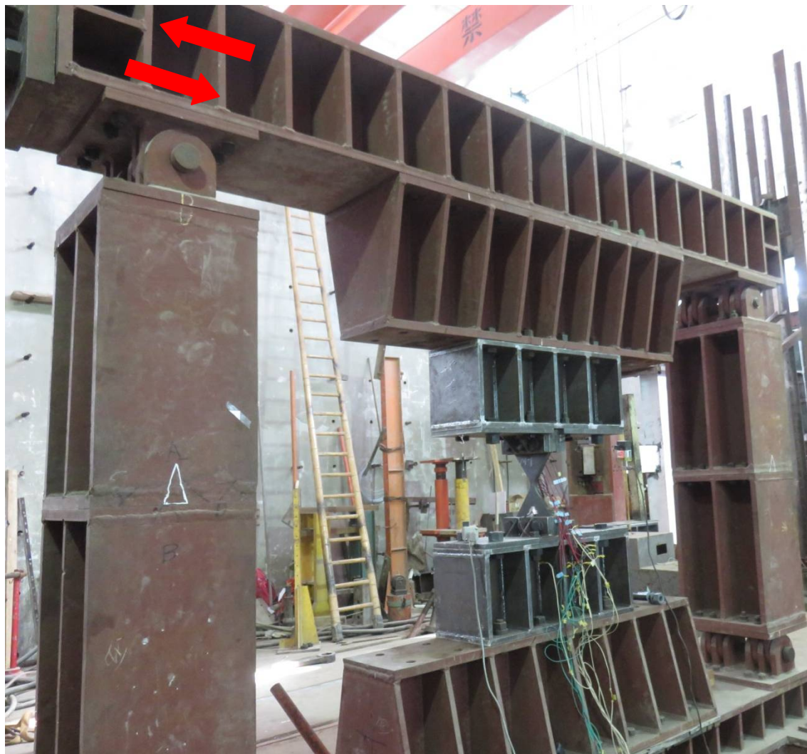
(b) 试验设备安装实物照片
