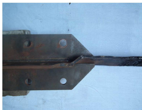
(b) 内芯端部非约束段扭转失稳破坏
