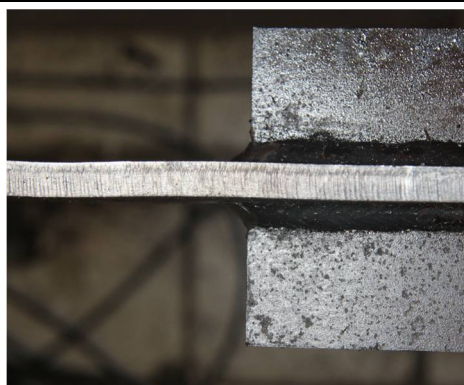
(a) 加劲肋端部焊缝光滑处理
