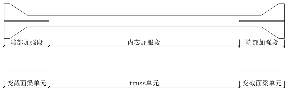
图 4.29 屈曲约束支撑简化分析模型
