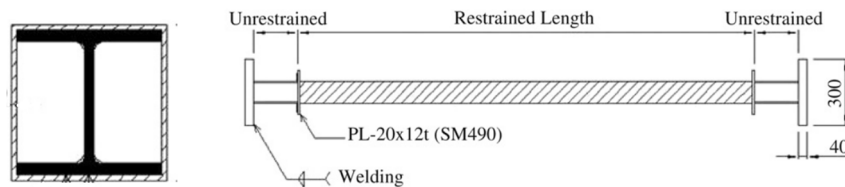
图 1.8 H 型钢内核方钢管约束型屈曲约束支撑
