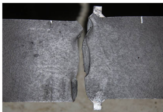
(c) IBRB3 内芯中部断裂
