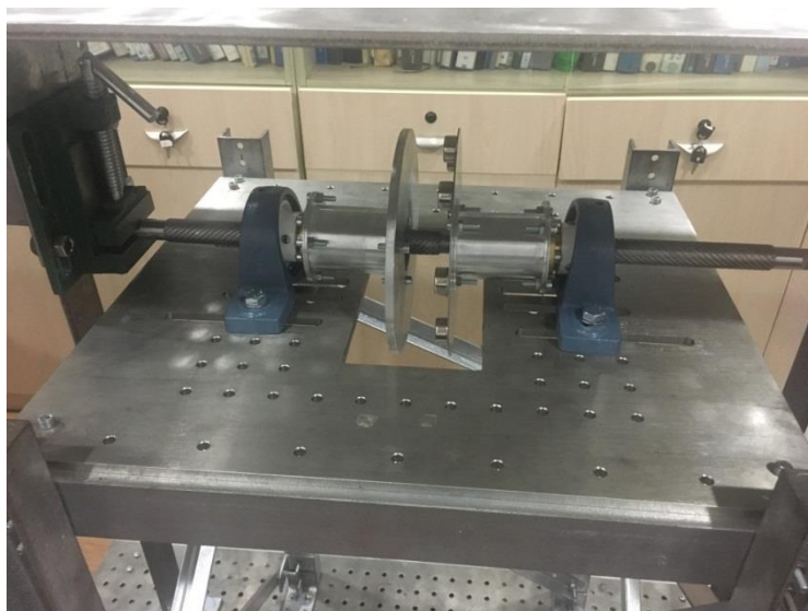
图 2.26 2080 梯形丝杆电涡流惯容系统模型组装实物图
