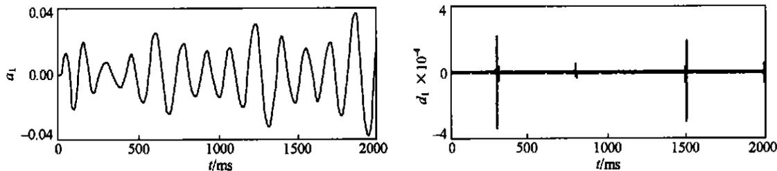
图 5(a) 第一层分解的低频概貌和高频细节信号
