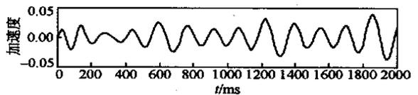
图 3 结构受激振后的动力响应
