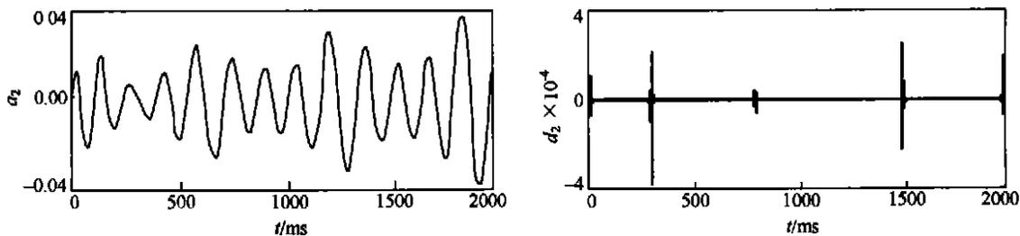
图 5(b) 第二层分解的低频概貌和高频细节信号
