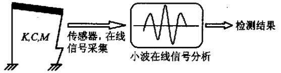
图 1 结构损伤在线检测
