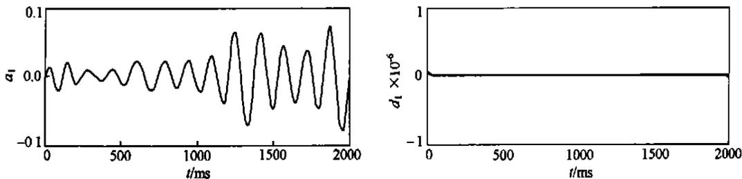
图 7(a) 第一层分解的低频概貌和高频细节信号
