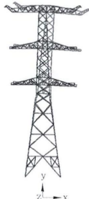
图3 结构第一振型 Fig. 3 The first vibration mode
