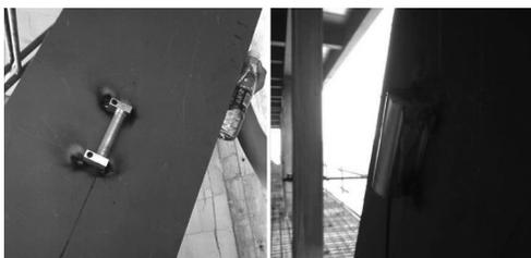
图7 腹杆上应变计及应变计保护罩
